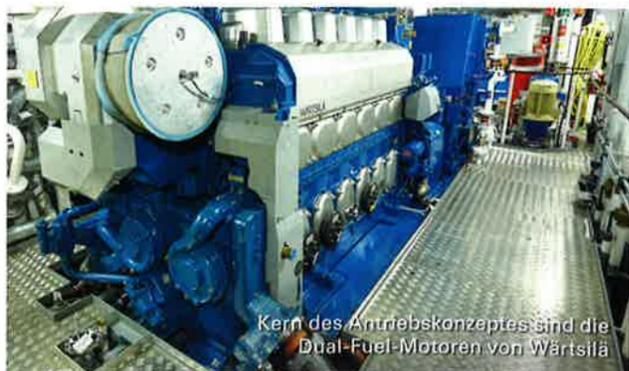
Kern des Antriebskonzeptes sind die Dual-Fuel-Motoren von Wärtsilä
