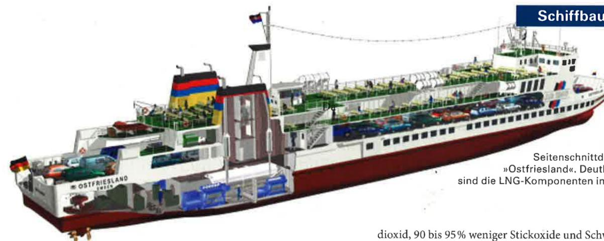
Seitenschnittdarstellung der »Ostfriesland«. Deutlich erkennbar sind die LNG-Komponenten im Heckbereich
